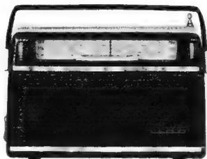
LIDO, UKW-, Mittel- und Langwelle, 9 Transistoren, 4 Dioden, 6 AM-, 9 FM-Kreise, 2stufiger Schwundausgleich, 1 Watt Ausgangsleistung.
