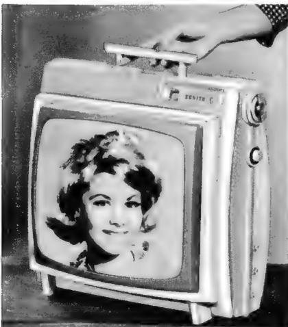
Tragbarer Fernsehempfänger mit 40-cm-Bildröhre. Das Gerät ist netzabhängig und mit Röhren bestückt
