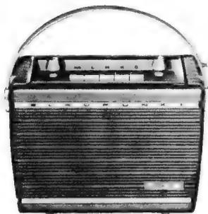
NIXE, Kurz-, Mittel- und Langwelle, 9 Transistoren, 3 Dioden, 7+1 Kreise, 2stufiger Schwundausgleich, 1 Watt Ausgangsleistung.
